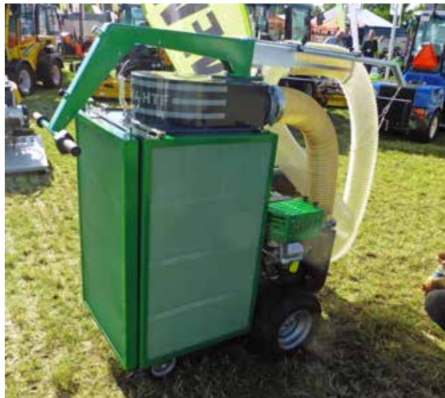
GMR's nye løvsuger kombinerer det bedste fra Stama og HTF. Den er bl.a. forsynet med en elmotor, så transporten til og fra arbejdsstedet kan foregå mere lydløst.
