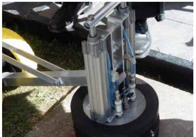
En forbedret membran øger den tid en Vac Man kan fastholde en flise, fra 20 sekunder til 2 minutter.
